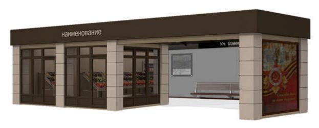
Панель фриза выполняется из алюминиевой композитной панели с защитнодекоративным покрытием. Цвет – RAL 8017 шоколад (BILDEX BL-8017). Надпись выполняется нанесением UV (ультрафиолетовой) печати или фрезеровкой (для табличек с внутренней подсветкой).
