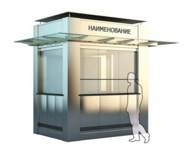
Панель фриза выполняется из алюминиевой композитной панели с защитнодекоративным покрытием. Цвет — RAL 9006 искрящийся металлик (BILDEX SCRATCH BS-1306 металлик вертикальный штрих). Надпись выполняется нанесением UV (ультрафиолетовой) печати или фрезеровкой (для табличек с внутренней подсветкой). Рекомендуется использовать голубой цвет подсветки.
