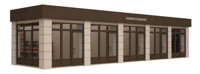
Панель фриза выполняется из алюминиевой композитной панели с защитнодекоративным покрытием. Цвет – RAL 8017 шоколад (BILDEX BL-8017). Надпись выполняется нанесением UV (ультрафиолетовой) печати или фрезеровкой (для табличек с внутренней подсветкой).
